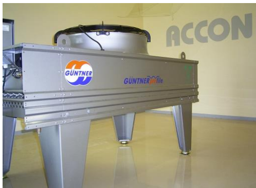
SchalleLeistungsbestimmung im Hallraum der ACCON GmbH in Greifenberg
